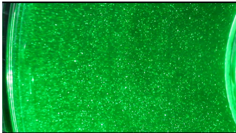
Figura 2.4: Fotograma experimental de partículas en nuestro aparato experimental, tomada para el caso en que el sistema tiene densidad de corriente aplicada y la esfera interna está en rotación.
