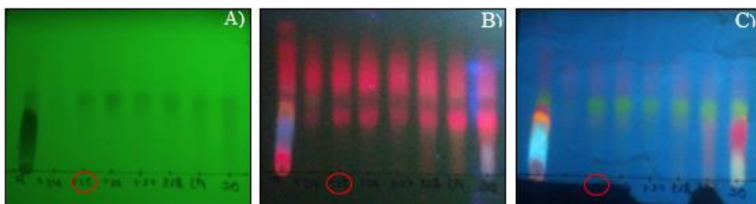
Figura 40. Cromatografía en capa fina FN vista en luz UV de la fracción VMC4F25. Sistema 5-5 hexano-acetato de etilo. A) Onda corta, B) Onda larga y C) Revelador Flavonoides.
