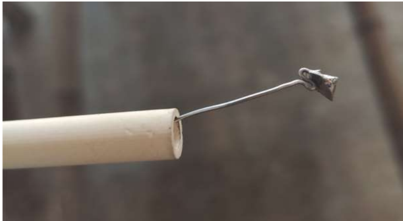
Figura 3.1 Arreglo de soldadura para electrodo de trabajo (ET)
