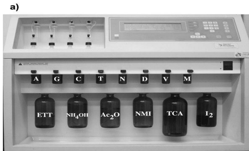
FIGURA 15. Sintetizador de ADN implementado para el ensamble de oligonucleótidos degenerados por el método de separación de resina.
