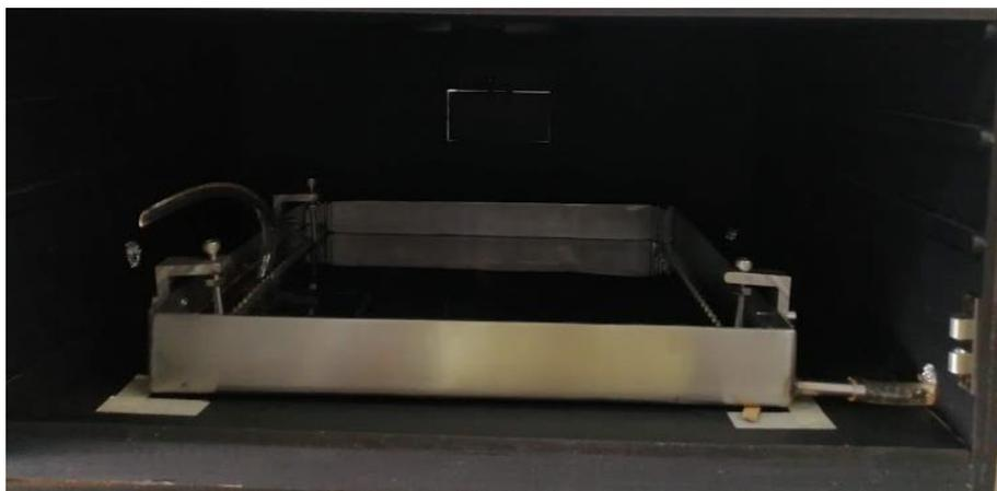
**Figura 12.** Reactor fotocatalítico dentro de la caja negra
