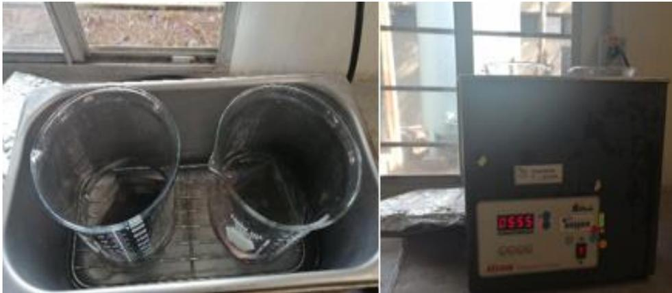
**Figura 22.** Lavado de láminas de  $\text{TiO}_2$  a baño ultrasónico.
