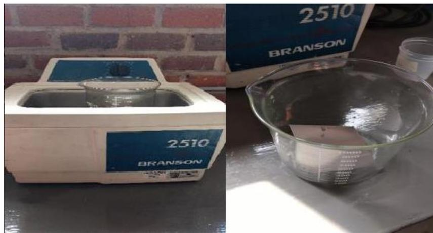
**Figura 6.** Lavado ultrasónico de láminas de Titanio
