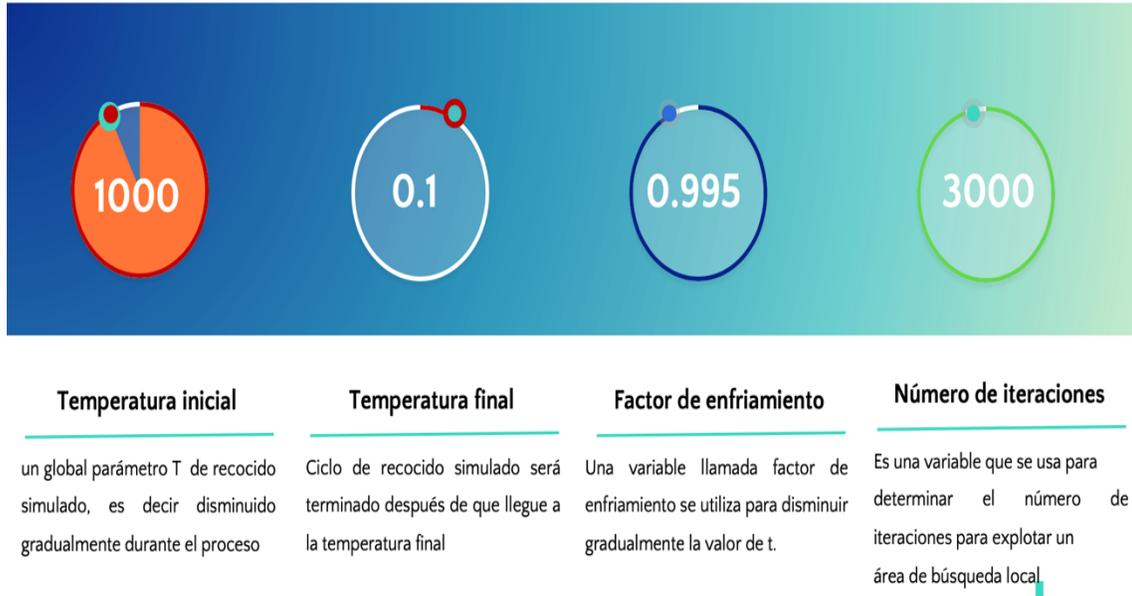
**Figura 3.8.** Parámetros de recocido simulado basados en (Mahmudy, 2014)
