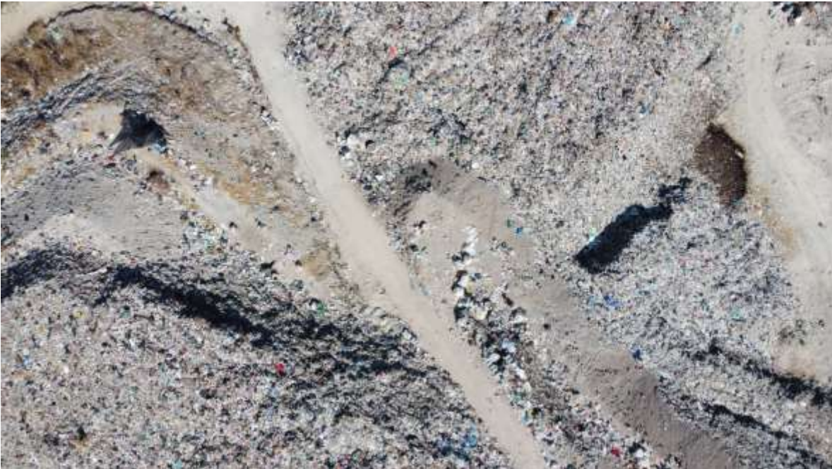
Figura 18. Parte central del relleno sanitario, donde se puede observar la falta de cobertura de los residuos y escurrimientos de lixiviados.
