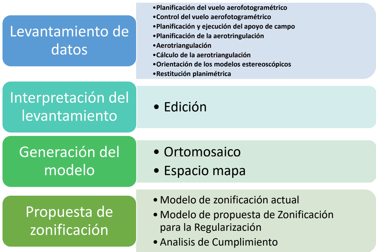
Figura 11.- Esquema de la metodología para la captura de datos, interpretación y generación del modelo de zonificación.
