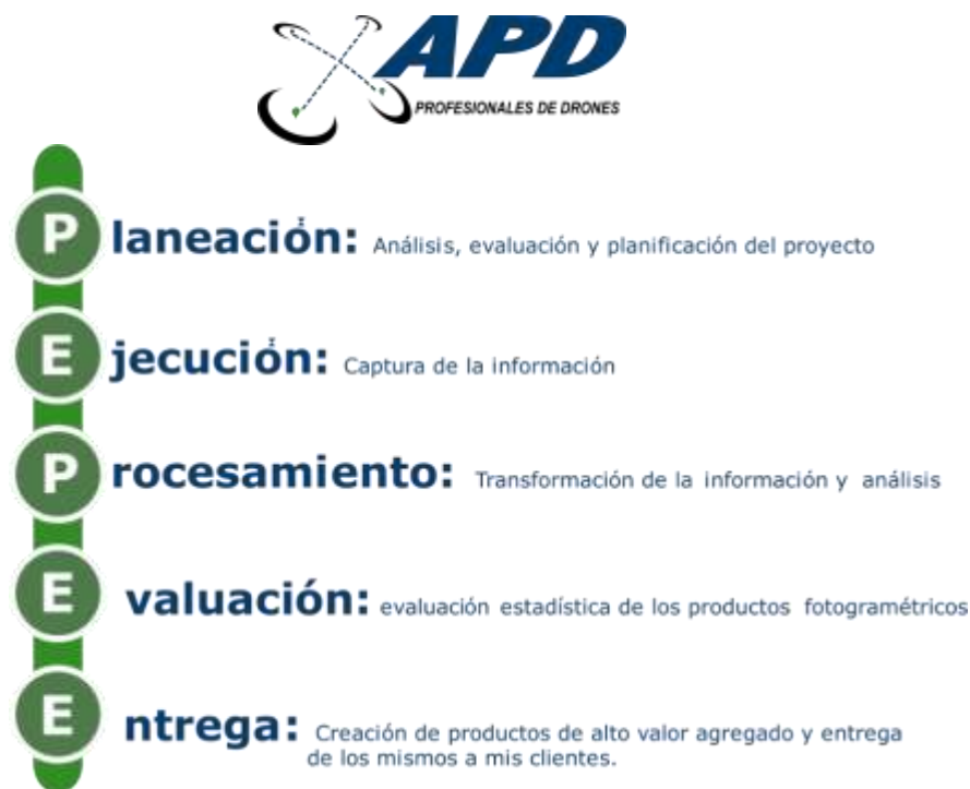
Figura 10.- Metodología propuesta por la Asociación Profesional de Drones APD, para hacer levantamientos aerofotogramétrico con drones. Fuente: www.apd.org .
