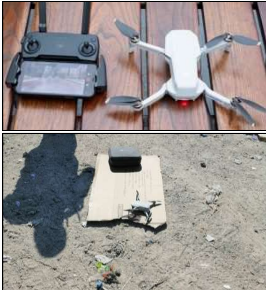
Figura 11.- el Drone DJI Mavic mini, que se utilizó para realizar el levantamiento de la información.
