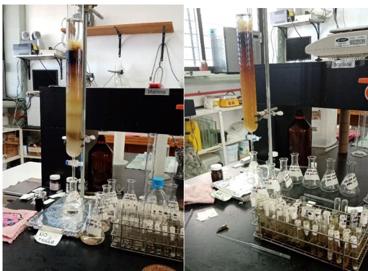
Figura 3 Cromatografía en columna abierta utilizada para la separación de los metabolitos secundarios del EDMBPL
