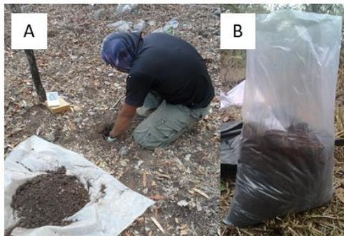
**Figura 6.** Extracción de muestra de suelo. A. Obtención de muestra de suelo compuesta de 5 a 20 cm de profundidad de la zona 2 caliza. B. Transporte de 2 kg de muestra en bolsas para posteriormente ponerlas a secar.
