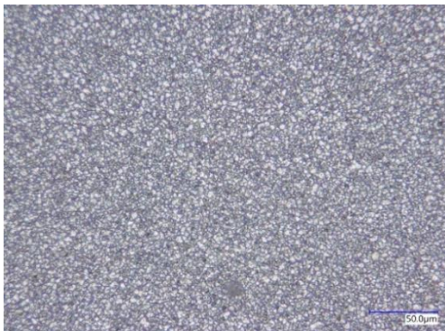
Figura 59: Imágenes de películas de perovskitas en microscopio óptico de refracción por distintos métodos de fabricación a) película fabricada por sublimación, b) película dopada con DIO, c) película con mezcla de precursores \text{PbI}_2 y \text{PbCl}_2 .
