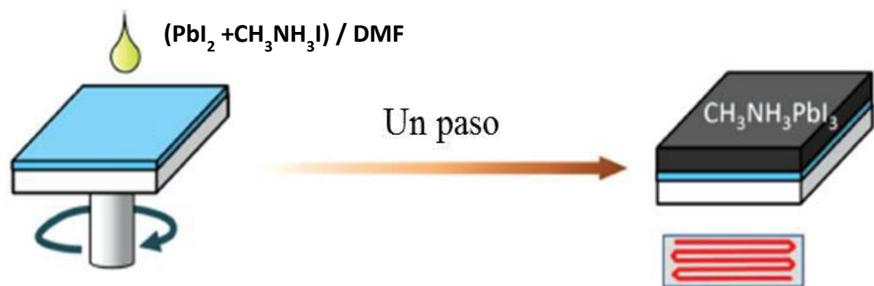
Figura 27: Ilustración del procedimiento para fabricar películas de perovskita por el método de un paso [37].
