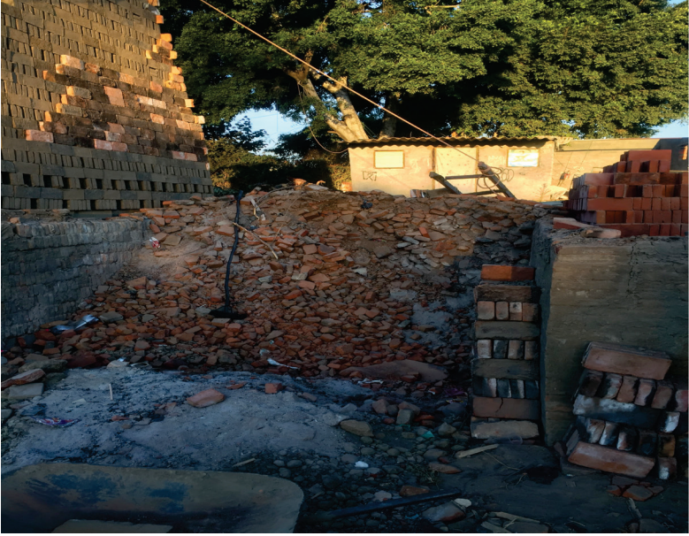
FIGURA 21. ALMACENAMIENTO DE LADRILLOS DEFECTUOSOS HORNEADOS
