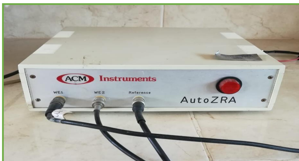
Figura 4.12 Equipo utilizado para las pruebas de ruido electroquímico de los recubrimientos.
