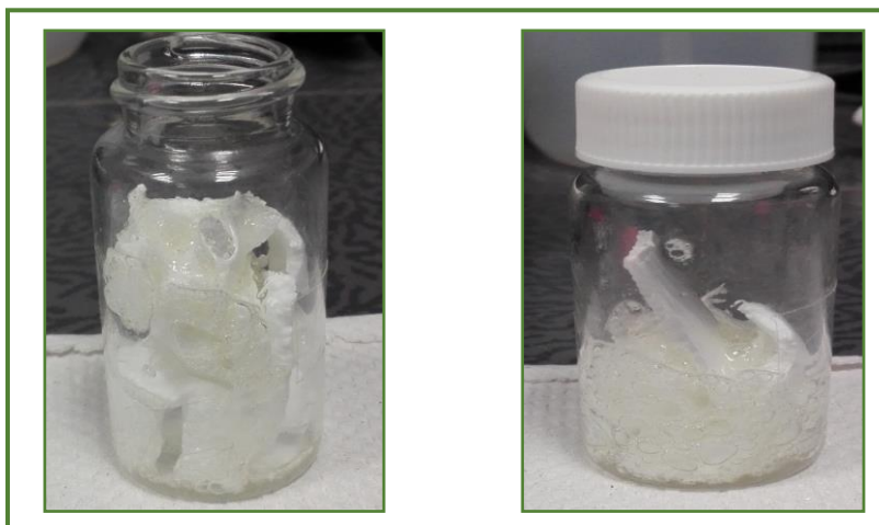
Figura 5.7 Disolución de poliestireno expandido (EPS)
