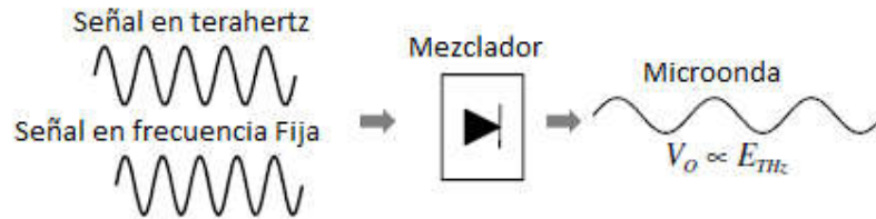
Figura II.4. Sistema de detección de terahertz basado en mezcladores.
