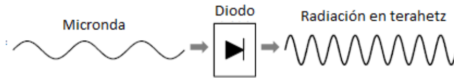
Figura II.3. Sistema de emisión de terahertz basado en diodos.
