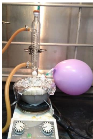
Figura 24. Reacción entre reactivo de Grignard y monómero a temperatura de reflujo (1h).
