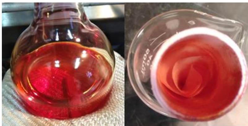
Figura 29. Izquierda: polímero disuelto en cloroformo, derecha: parte insoluble retenida en cartucho de celulosa.
