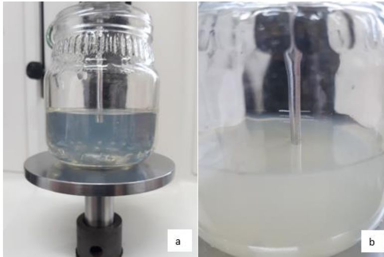
Figura 1. Evaluación de dureza (N) del gel del medio de cultivo MS solidificado con: a) phytigel, b) agar.
