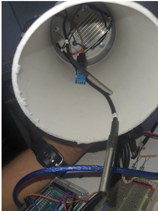
Figura 6.6. Sensores instalados dentro del sistema.
