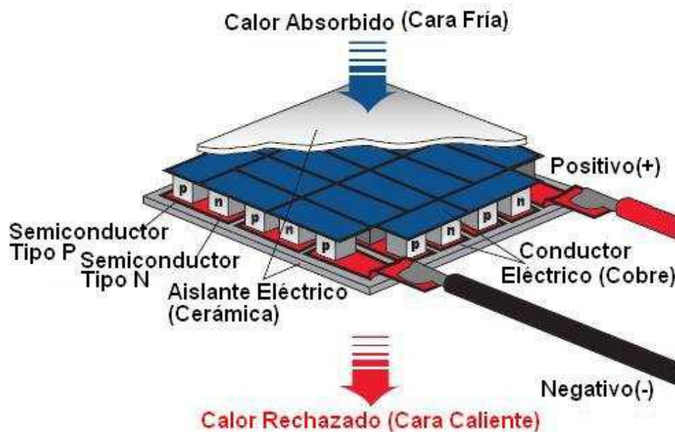
Figura 2.8. Estructura de placa Peltier.
