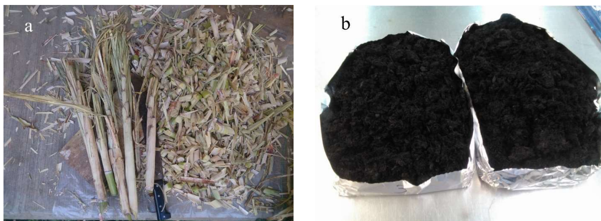
Figura 1. a) Biomasa de ápices de caña de azúcar. b) Biocarbón de ápices de caña de azúcar elaborado mediante carbonización hidrotérmica.
