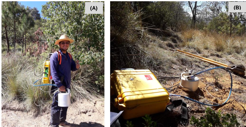
Fig. 5.12 Mediciones del flujo de CO 2 con el equipo de medición montado (A) e instalado en el subsuelo (B).
