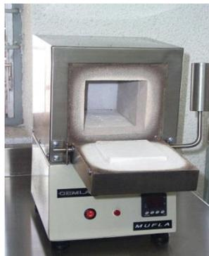
Figura 3.7. Mufla usada en los tratamientos térmicos.
