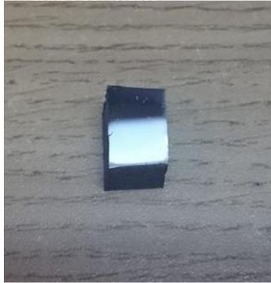
Figura 3.10. Pieza pulida a espejo para análisis metalográfico.
