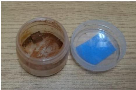
Figura 3.24. Muestra de óxido para fluorescencia de rayos X.
