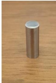
Figura 3.16. Probeta pulida para ensayo de dilatación.
