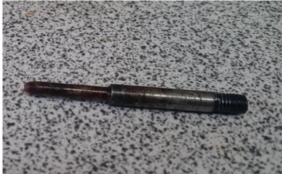
Figura 3.23. Probeta fracturada después del ensayo SSRT.
