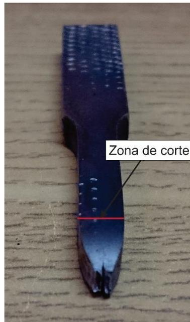
Figura 3.14. Zona de corte de la probeta fracturada.
