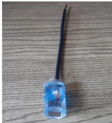
Figura 3.6. Probeta para ensayos de polarización potenciodinámica.
