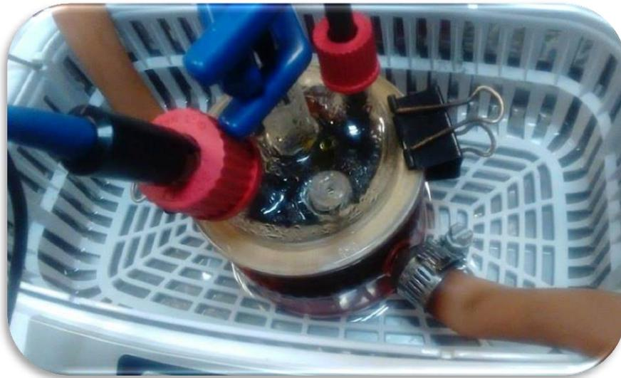
**Figura 3** Arreglo convencional de tres electrodos en celda electrolítica de vidrio de 4 bocas con chaqueta.
