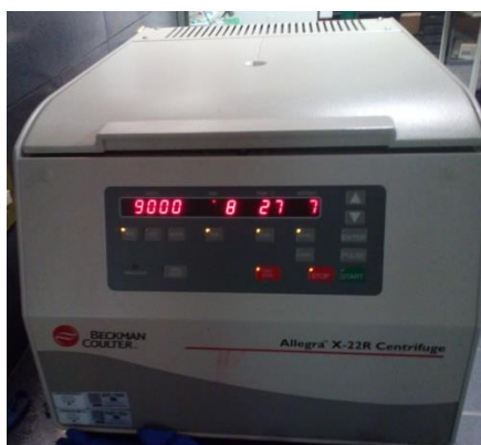
Figura 40. Lavado por centrifugación.
