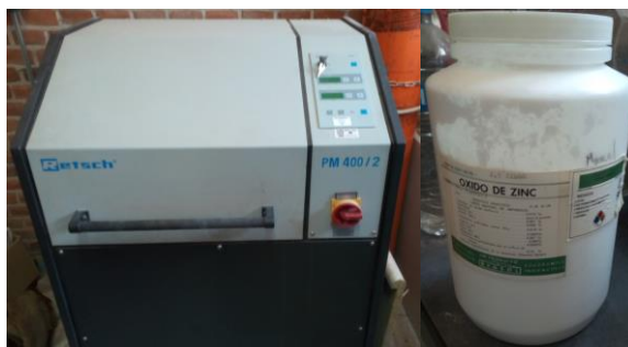
Figura 28. Pesaje y molienda del ZnO.
