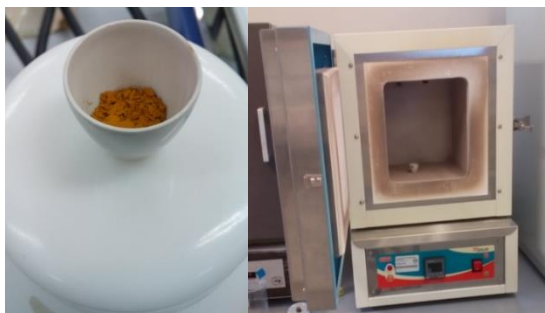
Figura 26. Tratamiento térmico de los polvos de \text{Fe}_3\text{O}_4 .
