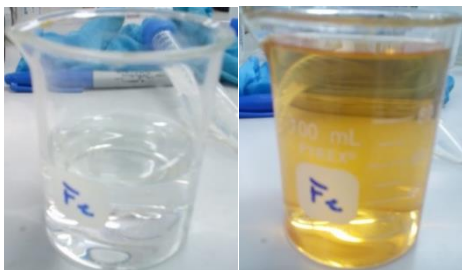
Figura 20. Solución precursora de Urea y Sulfato Férrico Amónico.
