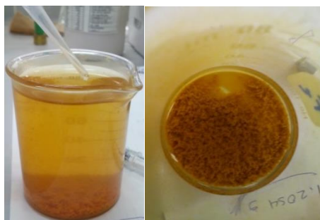
Figura 23. Sedimentación de los polvos de \text{Fe}_3\text{O}_4 .
