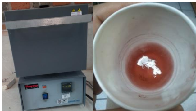
Figura 34. Tratamiento térmico del precipitado.
