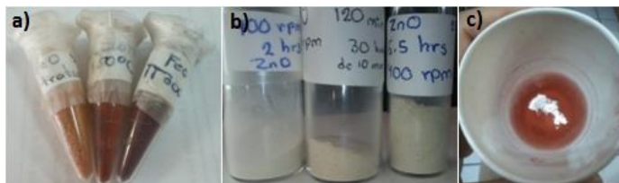
Figura 41. Nps de a) \text{Fe}_3\text{O}_4 , b) ZnO y c) \text{Fe}_3\text{O}_4@\text{ZnFe}_2\text{O}_4 .
