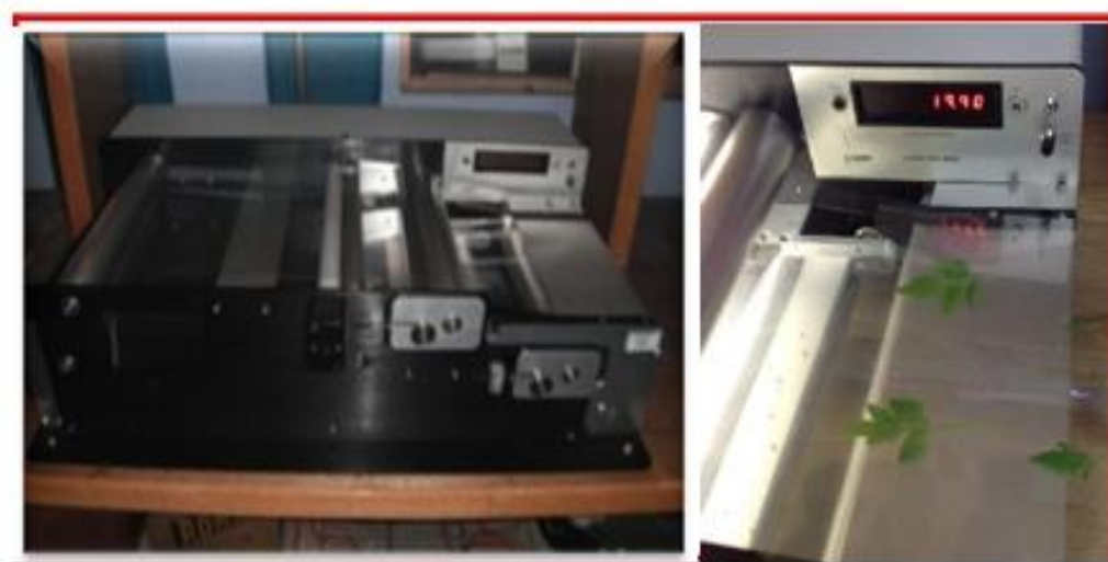
Figura 3.10 Spab equipo para medir área foliar.
