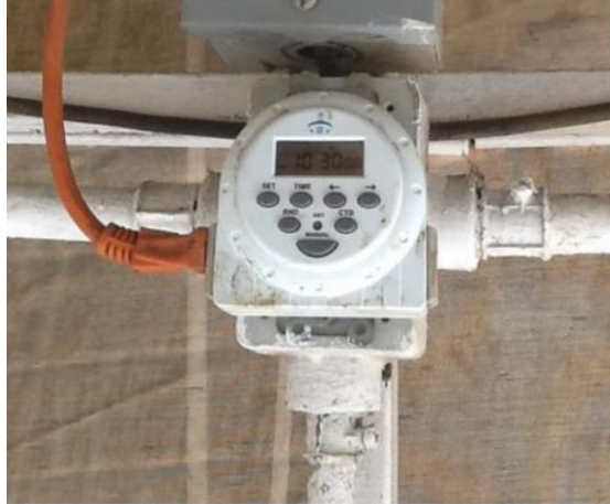
Figura 3.9 Temporizador (taimer) equipo para programar riegos
