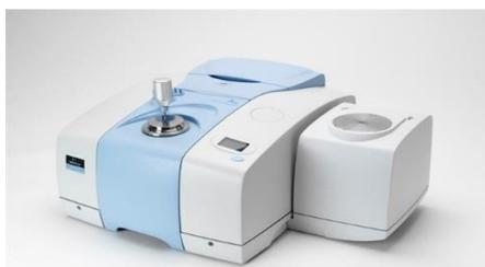
**Figura 11.** Equipo para el estudio de FTIR Frontier Perkin Elmer. <sup>48-49</sup>
