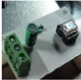
Figura 4.28 Filtro RC y fotodiodo PIN en placa fenólica.
