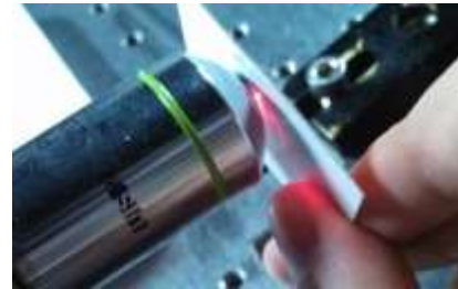
Figura 4.11 Ajuste de la distancia focal en la lente microscópica.
