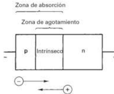
Figura 3.38 Construcción de un fotodiodo PIN . [43]
