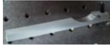
Figura 5.40 Superficies reflectora cóncava de radio 2.25 cm.
