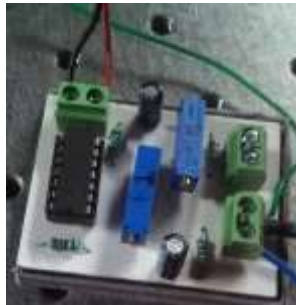
Figura 5.44 Circuito amplificador con el LM324 con ganancia de 9.8.
