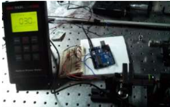
Figura 4.12 Medición de la potencia del diodo láser después de haber confinado la luz con el objetivo microscópico ( 3mW ).
