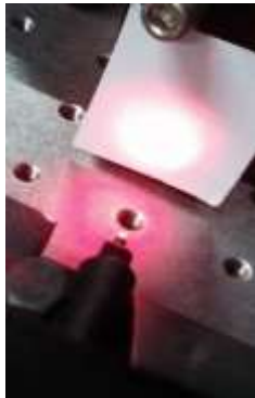
Figura 4.16 Emisión del haz de luz en la fibra óptica (luz dispersada).
