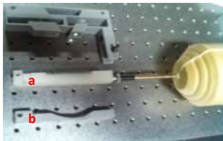
Figura 5.10 Superficies reflectoras del prototipo 3. a) Plana b) Cóncava (radio 4.6 cm).
