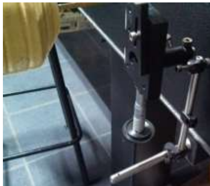
Figura 4.49 Uso de un elemento mecánico para el desplazamiento del sensor (superficie reflectora) para obtener la inclinación (ángulo de operación).
