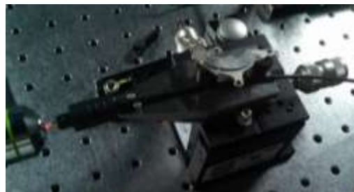
Figura 4.13 Colocación de la fibra óptica de plástico en una estructura mecánica de desplazamiento de 3 ejes.
