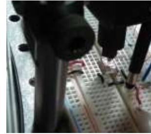
Figura 4.23 Ajuste y colocación perpendicular de la fibra receptora hacia la zona de recepción del fotodiodo.
