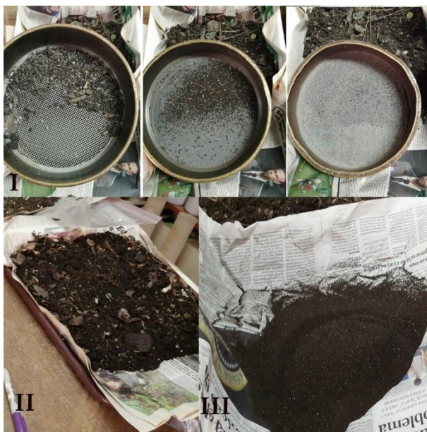
Figura 56. Procesamiento de muestras de suelos. I) tres tipos de tamiz por las que pasaron las muestras de suelo; II) muestra seca y III) muestra después del tamizado.
