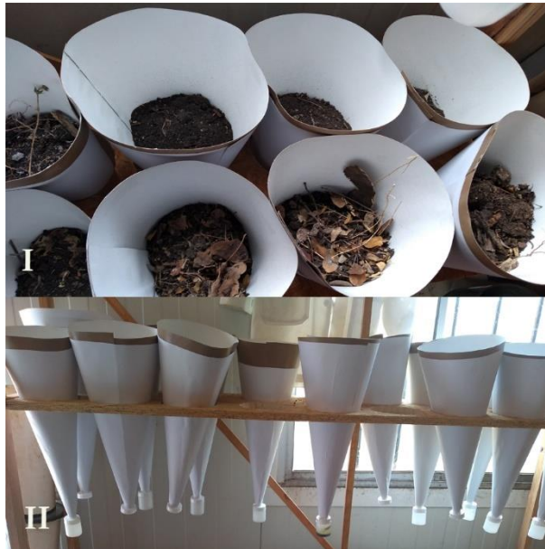
Figura 23. Procesamiento de las muestras edáficas. I) Embudos con muestras de suelo para ser procesadas y II) embudos elaborados para procesar muestras (Imagen de Figueroa, D).
