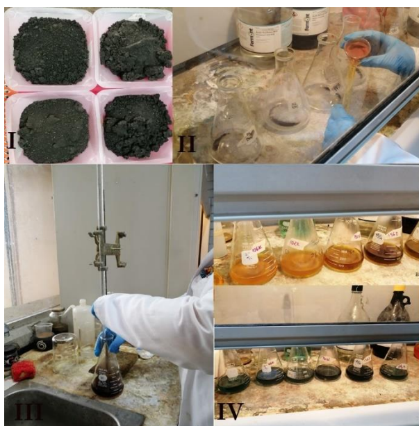
Figura 58. Determinación de materia orgánica. I) Muestra de suelo; II) dicromato de potasio, III) titulación con sulfato ferroso; IV) muestras después de la titulación.
