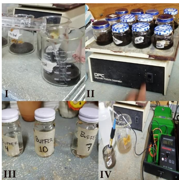
Figura 57. Determinación de pH. I) solución KCL en las muestras; II) muestras agitándose durante 30min; III) Buffer utilizados y IV) toma de lectura.
