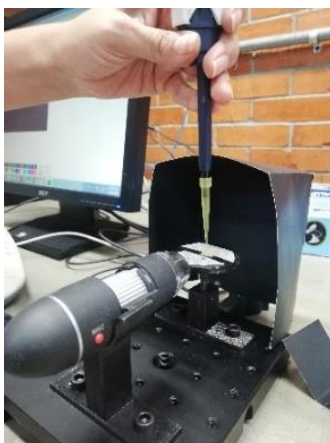
Figura 12 Montaje de la técnica de gota sésil para determinar el ángulo de contacto.
