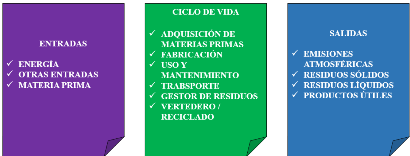
Figura 11. Cadena de análisis del ciclo de vida como un esquema general del mismo. Modificado de: (Díaz, 2011)
