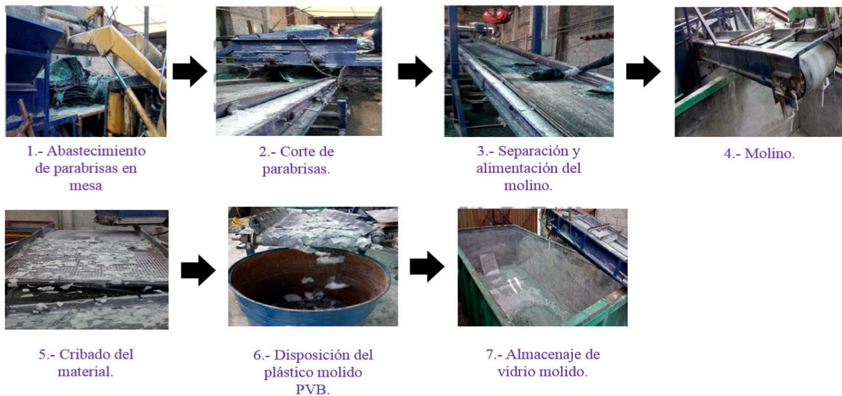
Figura 23. Etapas del proceso de des-laminado de la Planta Recicladora de Vidrio.
