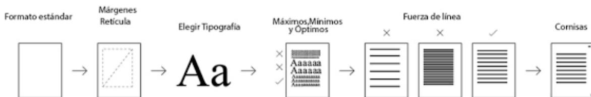
**Diagrama 2.** Proceso de maquetación por método sustractivo.
