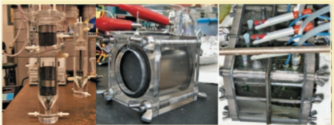
Figura 2.10. A) CCM con flujo ascendente; B) CCM con una sola cámara con cátodo expuesto al aire; y C) CCM de lecho empacado (Logan et al., 2006).
