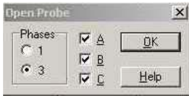
Fig. C.7 Punta de prueba de tensión trifásica en ATPDraw .
