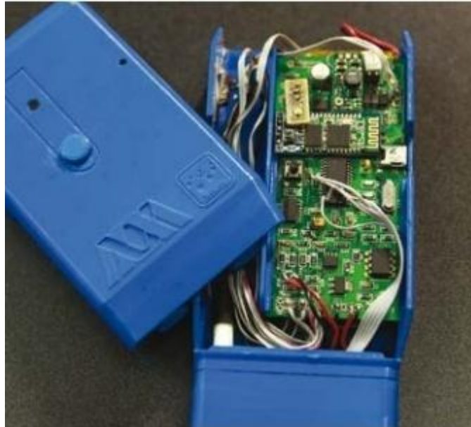
Figura 1.3: Equipo medición calidad del agua desarrollado UAM. Fuente: (Semanao_UAM, 2017)
