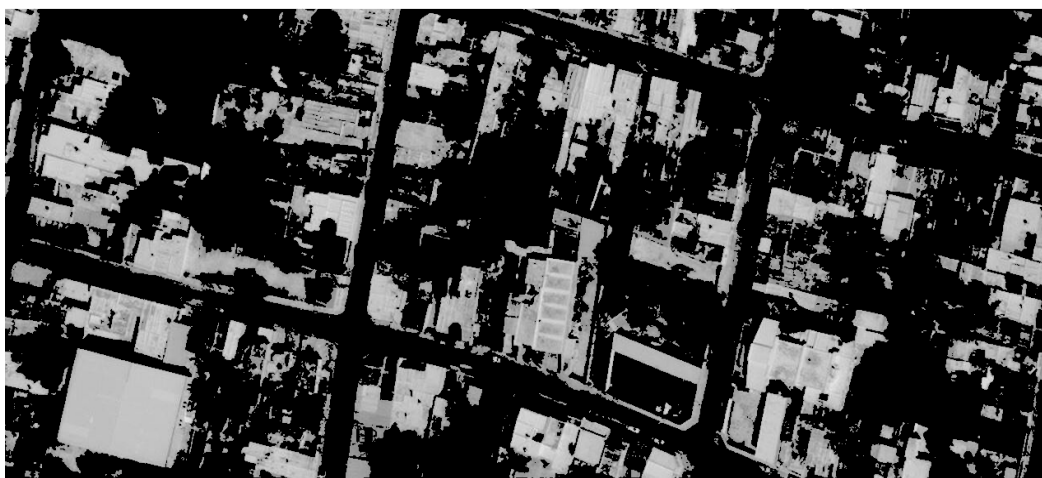
Figura 27 - Imagen Escala de grises del Método Otsu
