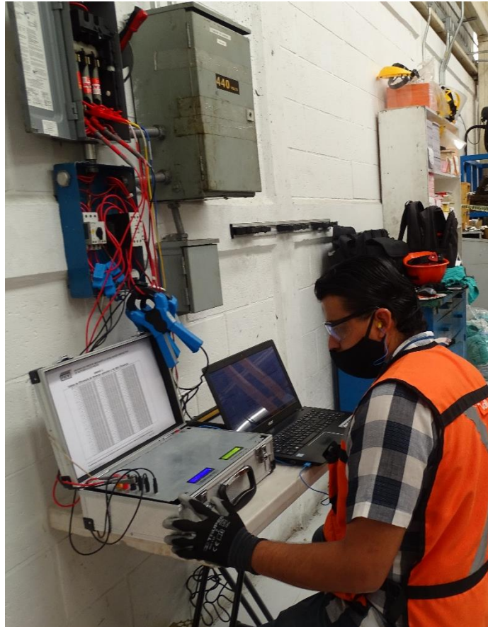
Figura 4.6. Ejecutando la prueba de desempeño del simulador en campo.
