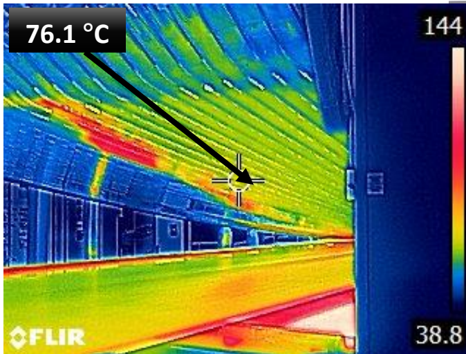
Figura 2.11 Fotografía termográfica de la zona seleccionada. Mesa de secado.
