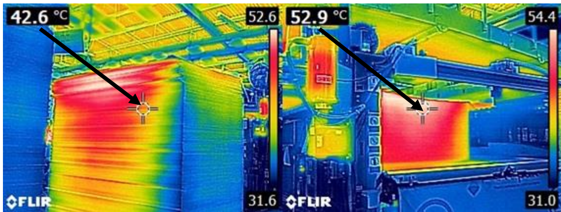
Figura 2.10. Fotografía termográfica de la zona de descarga.
