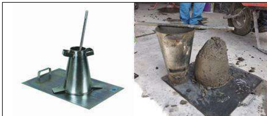
Figura 2.4. Cono de Abrams para prueba de asentamiento.
