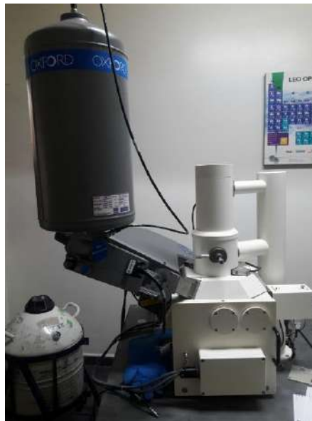
Figura 3.23. Microscopio electrónico de barrido (MEB).
