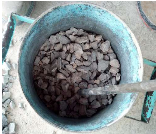
Figura 3.5. Compactación de la tara con la varilla de apisonamiento.
