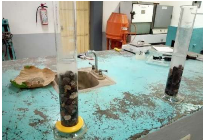
Figura 3.8. Medición de la densidad del agregado grueso.
