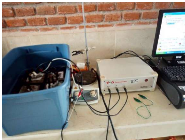
Figura 3.26. Técnica de resistencia a la polarización lineal.
