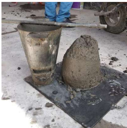
Figura 3.12. Prueba de revenimiento al concreto fresco.
