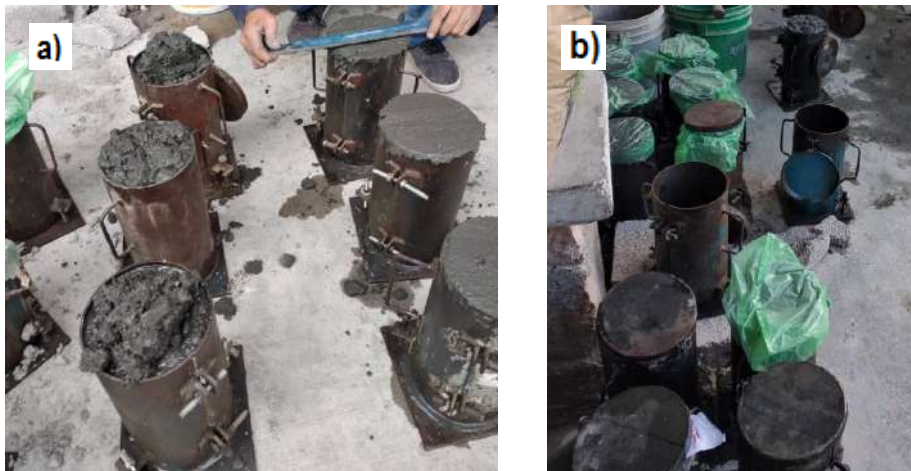
Figura 3.16. a) Enrase de cilindros de concreto, b) Protección de especímenes por contaminación.
