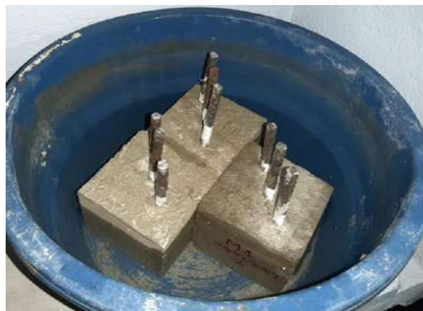
Figura 3.19. Curado de especímenes cúbicos.
