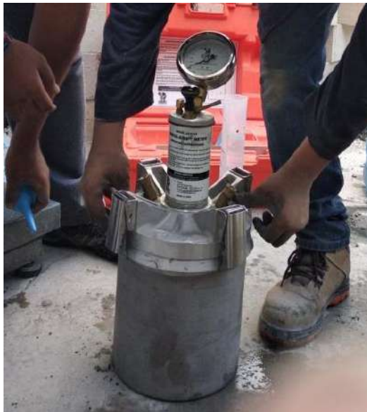
Figura 3.14. Cierre hermético de la tapa del medidor tipo B para contenido de aire del concreto.
