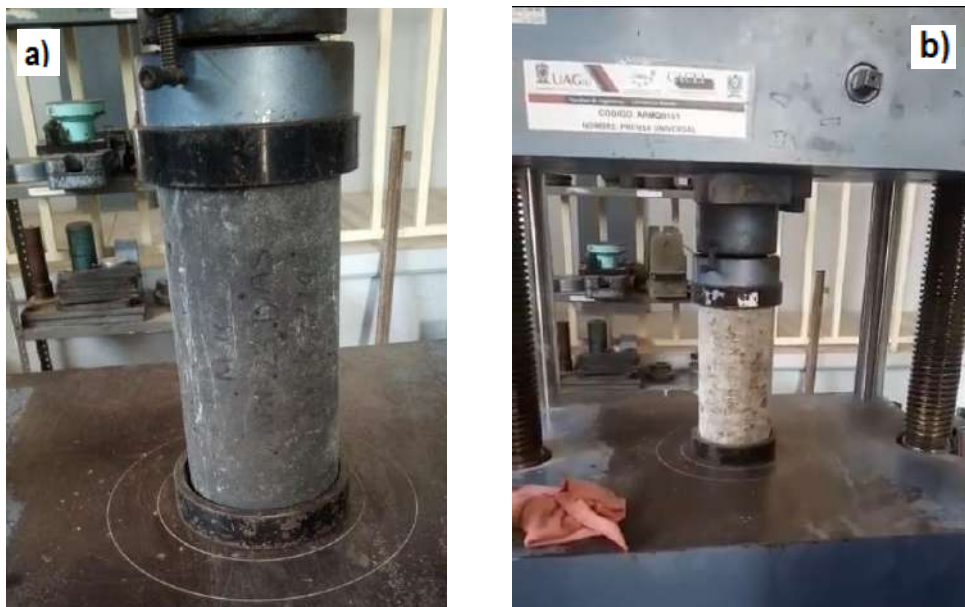
Figura 3.21. a) Placas de neopreno puesta a los extremos del espécimen, b) Ensayo a compresión.
