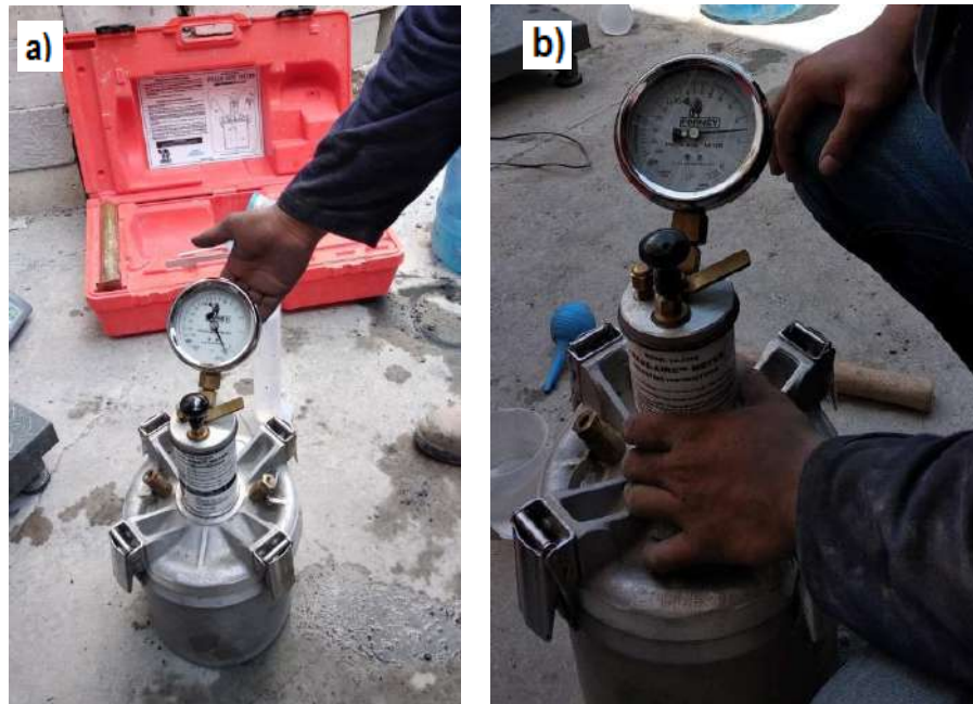
Figura 3.15. a) Prueba del porcentaje de contenido de aire, b) Estabilización de la aguja del medidor tipo B.
