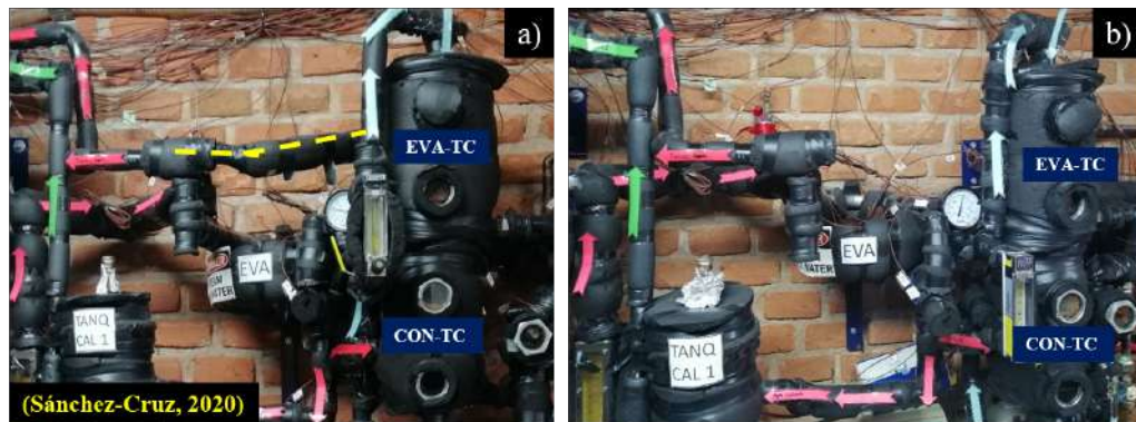
Figura 5.4: Mejora física 3: eliminación de tubería
