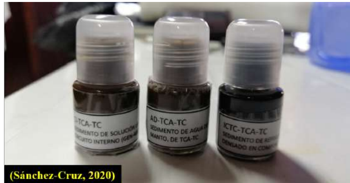
Figura 5.2: Sedimento recolectado del circuito interno y externo del TCA-TC
