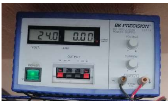
Figura 3.15: Fuente de poder para transductores de presión
