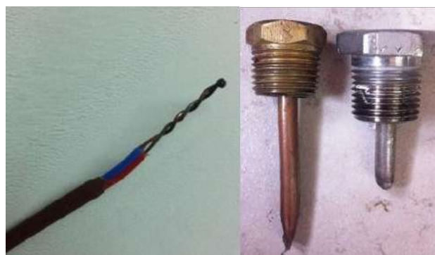
Figura 3.16: Termopar y termopozos en el TCA-TC
