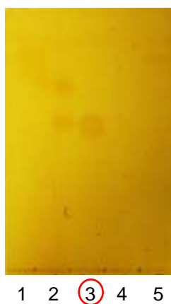
Figura 7.13. CCF de la CCA 9 de P. taxifolius : Muestra: fracción 2 (CCA6) FM: CHCl 3 : Acetona 5:0.5; FE: sílica gel; Cx: control; Revelador: Wagner.
