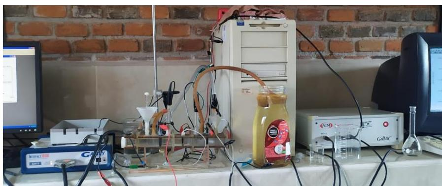
**Figura 3.5** Celda electroquímica para las pruebas de permeabilidad de hidrogeno.
