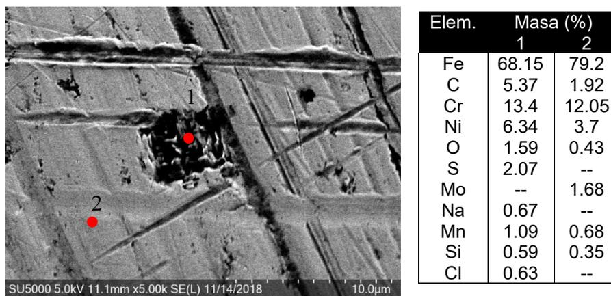
**Figura 4.41.** Análisis por EDS en una picadura sobre la superficie del acero UNS S41425 expuesto durante 24hrs en la solución A NACE con  $1 \times 10^{-3}M$  de  $Na_2S_2O_3$  y con una concentración de 100ppm del inhibidor a una velocidad de flujo de 1000 RPM.
