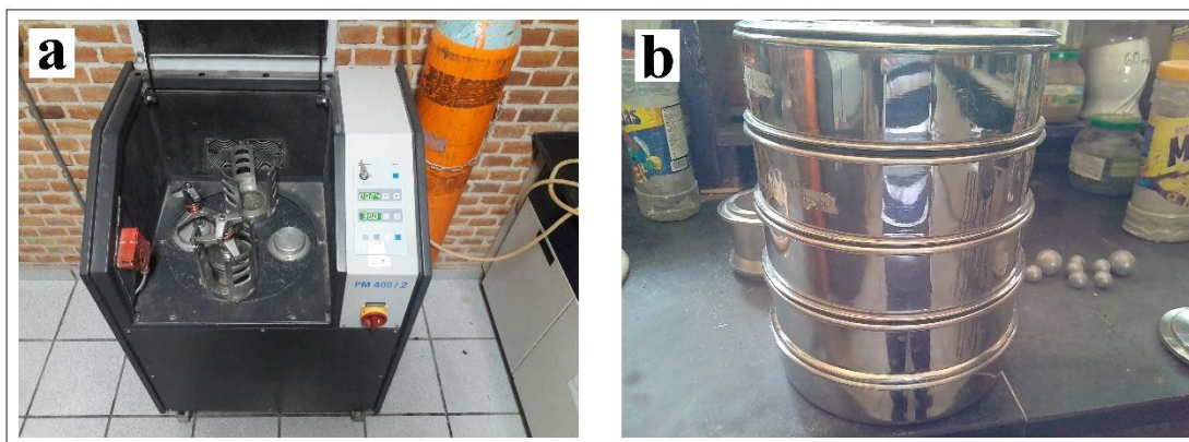
Figura 3.14. Equipo de molienda a) Molino de bolas, marca Retsch PM 400/2 b) Tamices marca Monti-inox.
