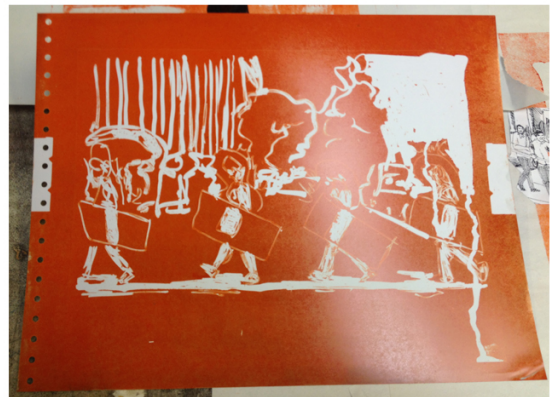
Placa, pre sensibilizada, entintada para su impresión (Proceso)
