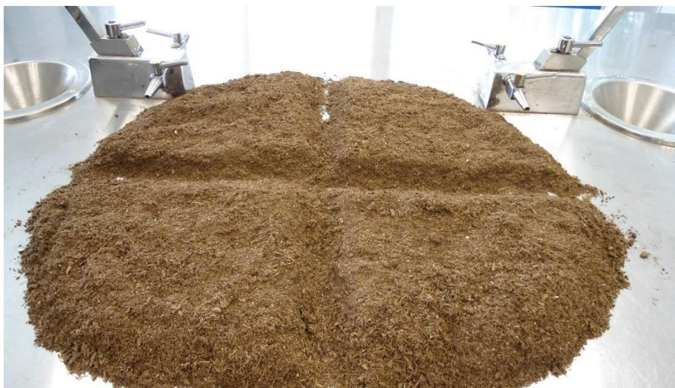
Figura 1. Técnica de cuarteo para homogeneizar el sustrato.
