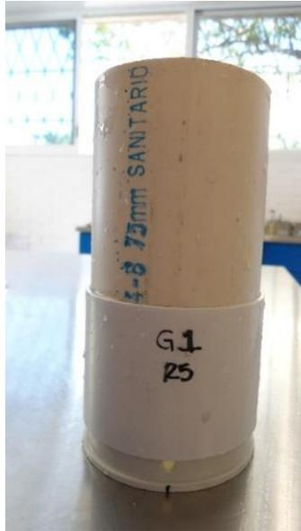
Figura 2. Porómetro.
