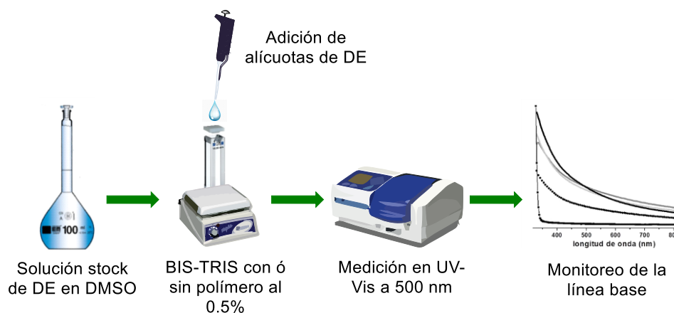
Figura 23. Esquema general de la técnica de solvent shift , se empleó BIS-TRIS como medio con o sin polímero.
