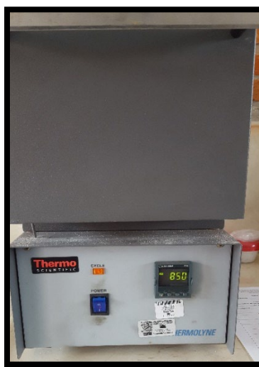
Figura 10 Aplicación de los TT para obtener un Temple, empleando una mufla.
