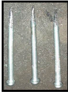
Figura 24 Tornillos después de darles un acabado en punta en la esmeriladora.
