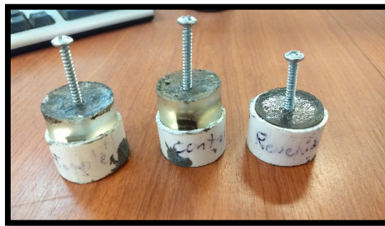
Figura 25 Resultado final del atornillado en las probetas.
