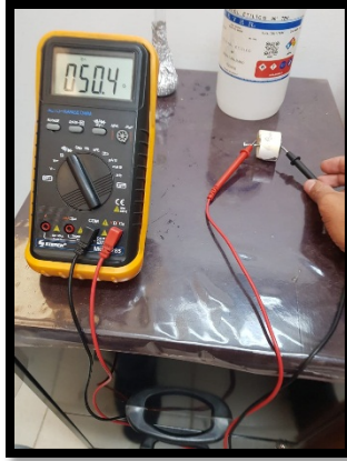
Figura 26 Prueba de Continuidad Eléctrica para cada una de las probetas.
