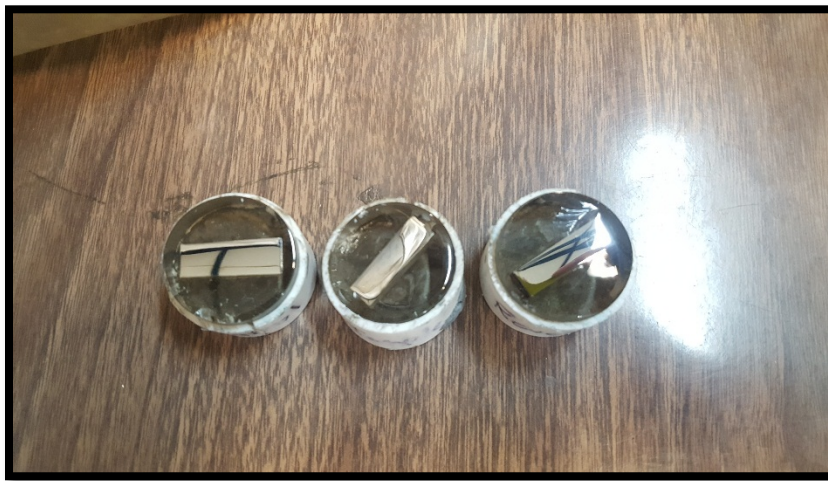
Figura 22 Resultado final del proceso de pulido a espejo, empleando Al_2O_3 .
