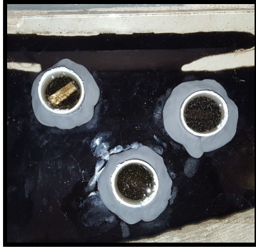
Figura 16 Proceso final de encapsulamiento de probetas.
