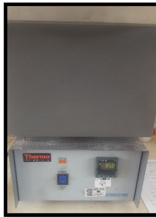
Figura 12 Aplicación de los TT para obtener un Revenido, empleando una mufla.
