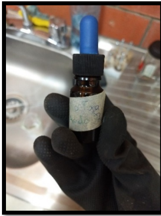
Figura 27 Solución Química para atacar las probetas, Nital ( \text{HNO}_3 ) al 5%.
