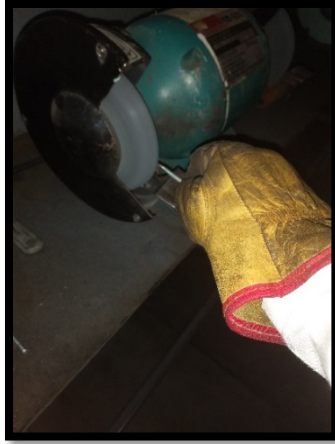
Figura 23 Uso de Esmeriladora en TAMULBA para darles un acabado en punta a los tornillos.
