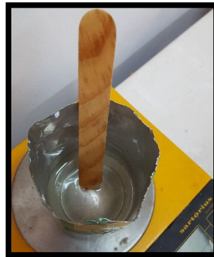
Figura 14 Mezcla de la resina con el catalizador.
