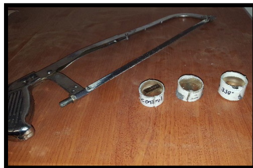
Figura 18 Extracción de las probetas encapsuladas de las tuberías de PVC.
