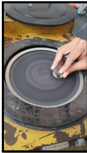
Figura 19 Empleo de la lija 120 utilizando pulidora mecánica de los laboratorios de TAMULBA.
