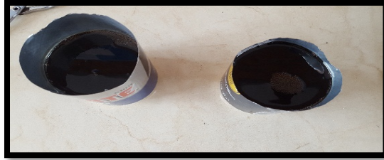
Figura 11 Enfriamiento de las probetas empleando aceite de motor.
