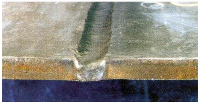
Figura 2-18 Socavación de cordón
