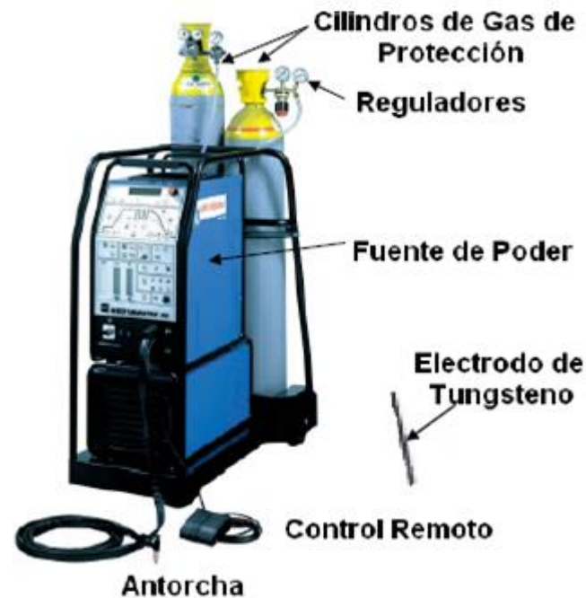
Figura 2-9 Equipo básico para proceso de soldadura TIG. [36]
