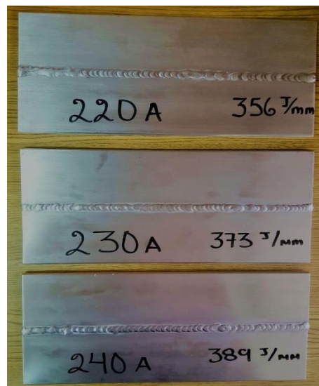
Figura 3-3 Placas de Al6061 T6 soldadas por TIG.
