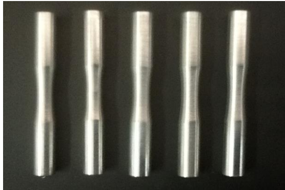
Figura 3-16 Probetas preparadas para el ensayo de fatiga.
