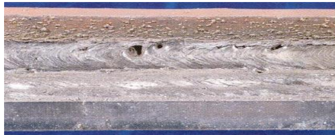
Figura 2-14 Inclusiones de escoria superficiales.
