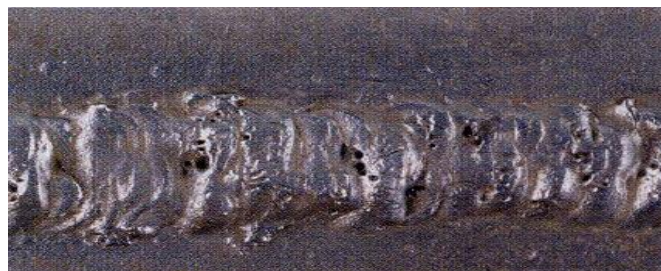
Figura 2-15 Poros superficiales aislados.
