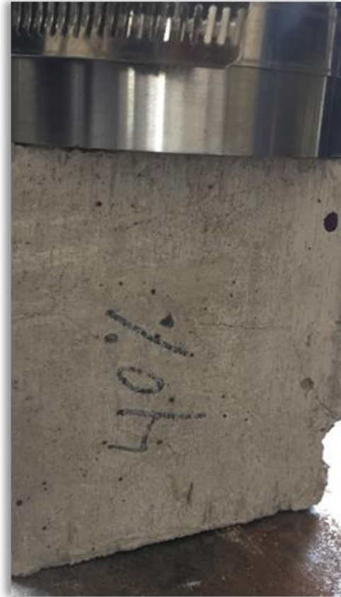
Imagen 19. Ensayo de resistencia a la compresión.
