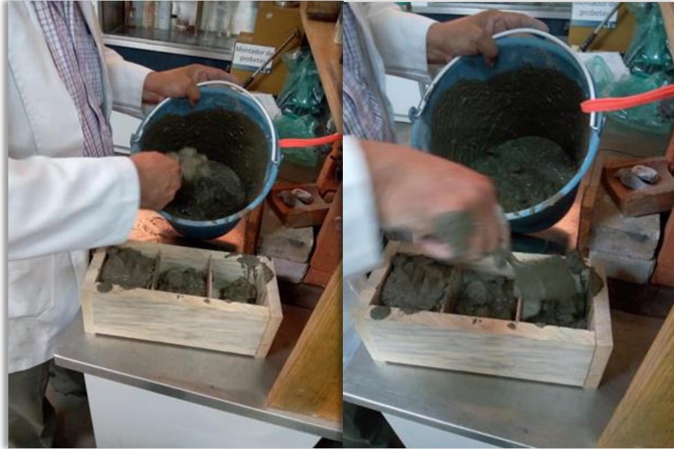
Imagen 12. Elaboración de especímenes de concreto.
