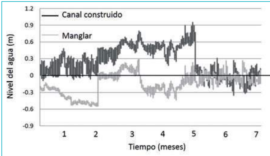
Figura 7 Variaciones temporales de los niveles de inundación en el canal restaurado y en una zona del manglar en restauración
