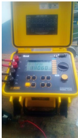
Figura 10. Microhommetro utilizado para las lecturas de resistencia eléctrica.
