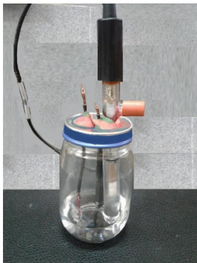
Figura 14. Fotografía de la celda de tres electrodos utilizada para los ensayos electroquímicos de polarización e impedancia.
