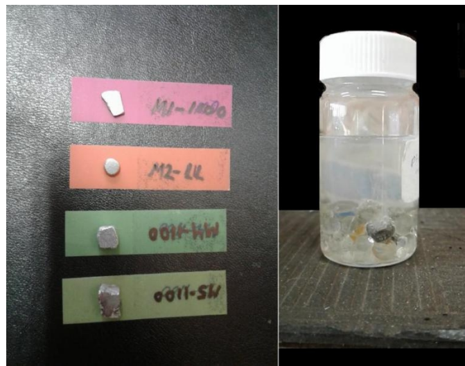
Figura 16. Experimento de corrosión química y muestras representativas de las aleaciones de AlCoMn.
