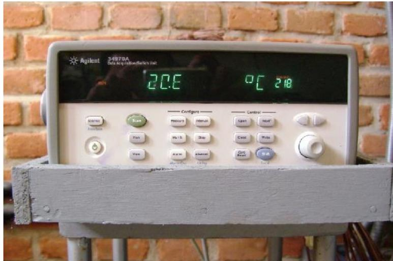
Figura 3.6 Sistema de Adquisición de datos Agilent
