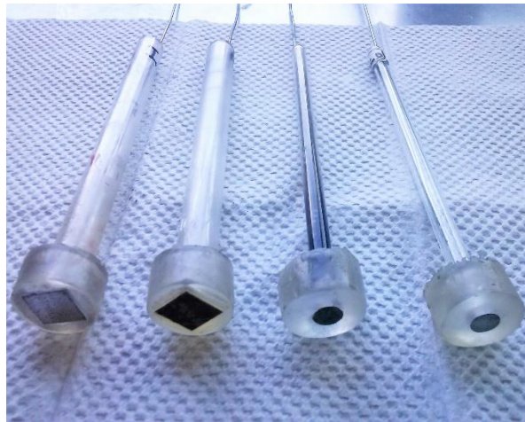
Figura 18. Muestras encapsuladas de las 4 aleaciones.
