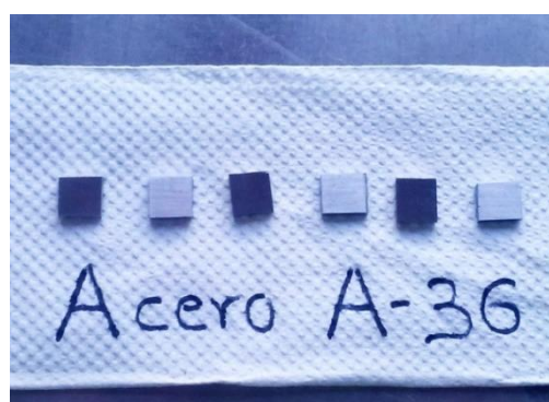
Figura 17. Muestras recién cortadas.
