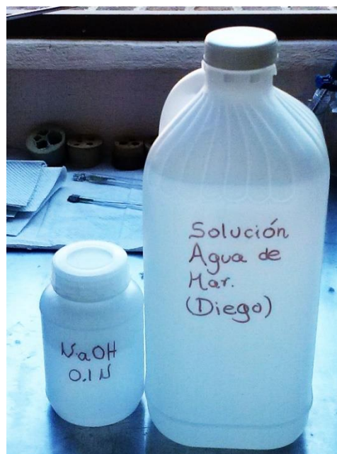
Figura 16. Elaboración del Agua de mar de acuerdo a la norma ASTM D 1141-98
