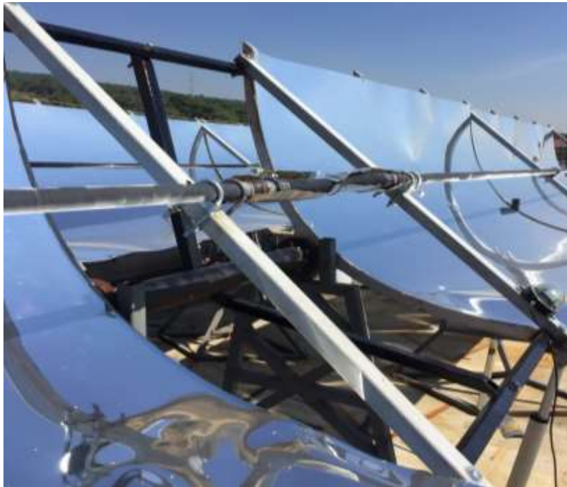
Figura 3.25 Dispositivos conectados por estructuras de soporte.
