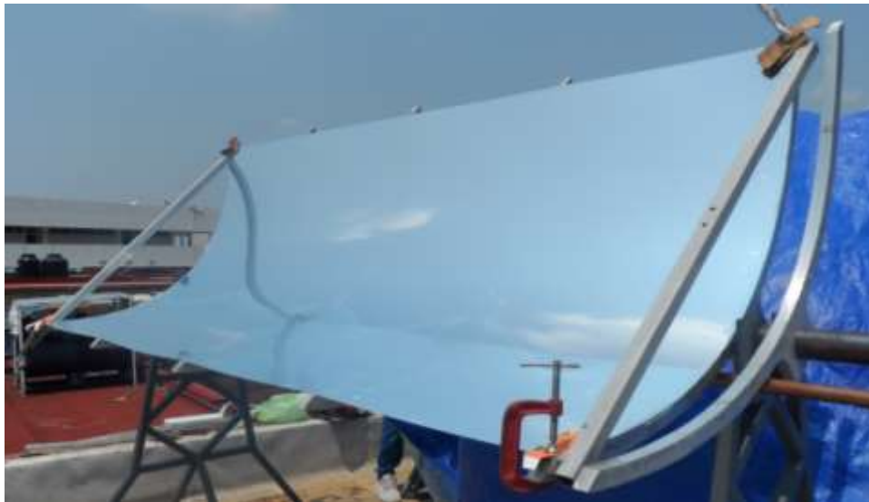
Figura 3.13 Lámina reflectora ensamblada a los perfiles parabólicos.
