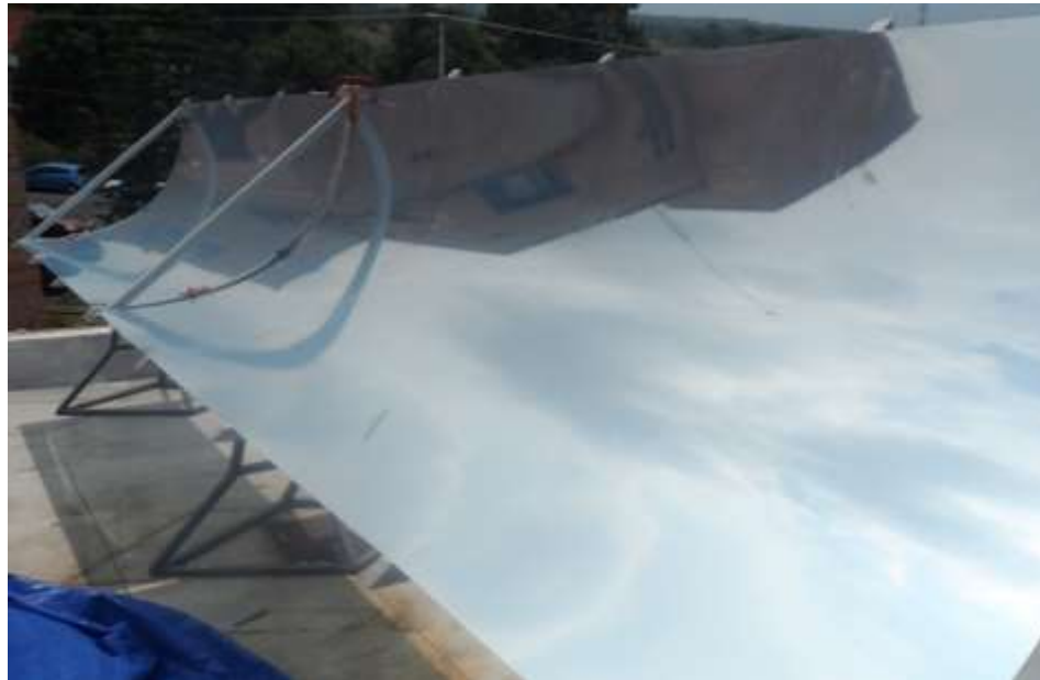
Figura 3.14 Ensamble de dos concentradores parabólicos.
