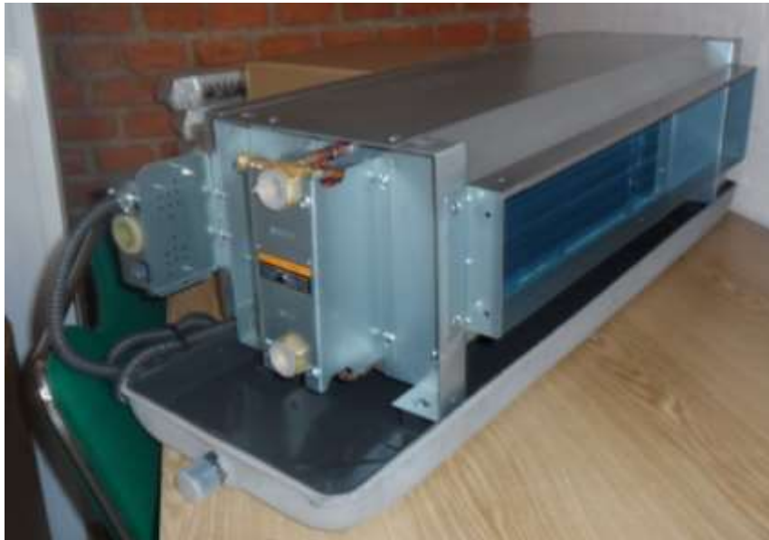
Figura 3.3 Unidad evaporadora \frac{3}{4} de tonelada de enfriamiento [Galindo-Luna].
